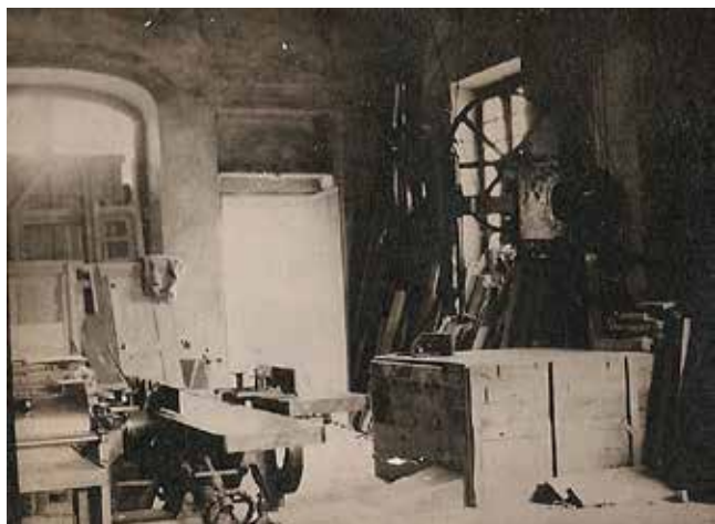
Interior de la fusteria tal com era fins els anys 40. A la dreta la serra-cinta.
